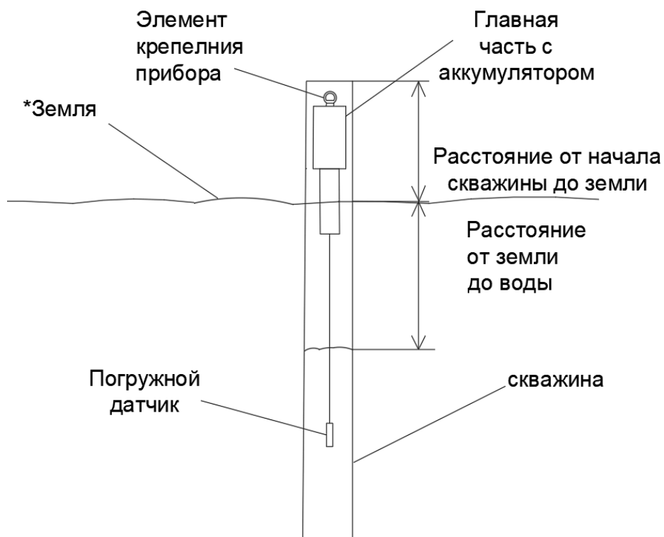
Рисунок 2 – Установка прибора в скважину заказчика.
